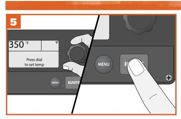
L'écran d'accueil affichera « Press dial to set temp. » (appuyer sur la molette pour régler temp.). Tourner la molette de sélection dans le sens horaire jusqu'à 177 °C (350 °F). Appuyez sur IGNITE (allumer), fermez la porte du barbecue et faites fonctionner le barbecue pendant 20 minutes une fois qu'il a atteint la température réglée.
