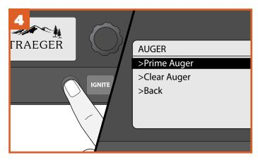
Appuyez sur MENU pour afficher le menu principal. Tournez la molette pour sélectionner AUGER (vis sans fin) puis sélectionner Prime Auger (amorcer vis sans fin).
